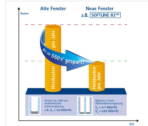
Beispiel für den Austausch veralteter Fenster aus den 90er-Jahren: In einem typischen Einfamilienhaus mit ca.  $28 \text{ m}^2$  Fensterfläche beträgt das Einsparpotenzial bis zu  $550 \text{ €}$  jährlich bei Einsatz von neuen Fenstern aus dem System SOFTLINE 82 MD.\*\*
