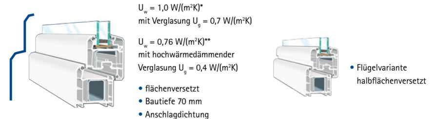
\*Beispiel für erzielbaren  $U_w$ -Wert mit Verglasung  $U_g = 0,7 \text{ W/(m}^2\text{K)}$  und  $\psi_g = 0,050 \text{ W/(mK)}$
